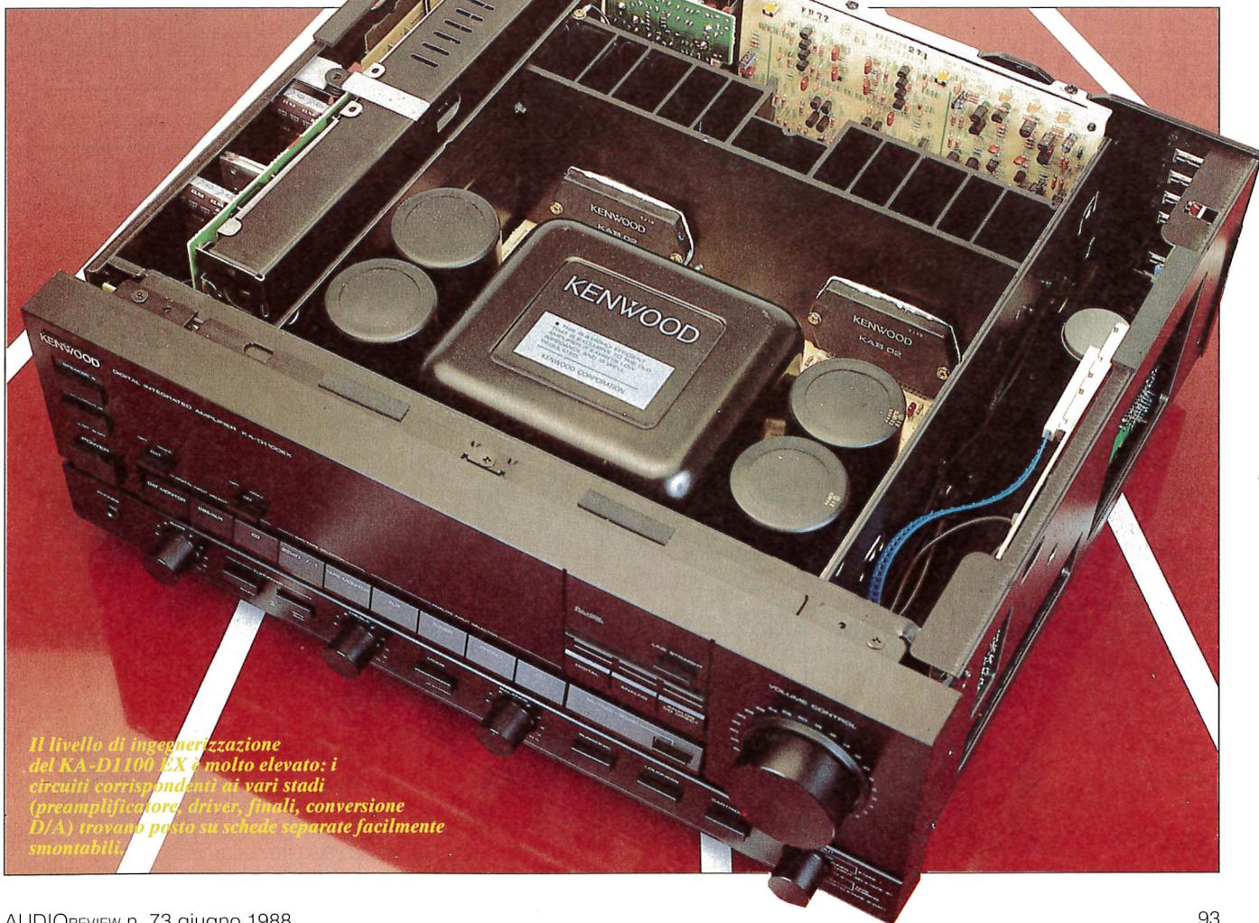
*Il livello di ingegnerizzazione del KA-D1100 EX è molto elevato: i circuiti corrispondenti ai vari stadi (preamplificatore, driver, finali, conversione D/A) trovano posto su schede separate facilmente smontabili.*
