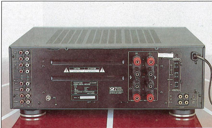
Sul pannello posteriore, oltre ai classici ingressi/uscite di tipo analogico, sono presenti (sulla destra del pannello) anche ben sette connettori (tre «ottici» e quattro «elettrici») per il collegamento di apparecchi dotati di uscita digitale (CD-player, registratori DAT, tuner DBS). Ottima la qualità dei connettori di uscita per i diffusori, che accettano sia terminazioni a banana che filo spellato anche di notevole spessore.
